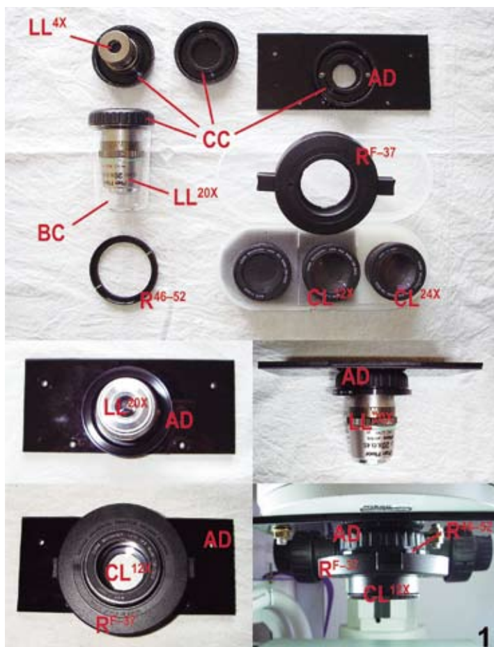
図1. 手製レンズアダプター (AD) と構成部品、規格外レンズ類。CC、レンズケースキャップ；BC、レンズケース本体；R 46-52 、ステップアップリング46mm→52mm；R F-37 、レイノックス「ミクロ探検隊」付属フリーレンズアダプター；LL 4X 、Nikon 生物顕微鏡用レンズ Plan Apo 4x/0.10；LL 20X 、Nikon 生物顕微鏡用レンズ Plan Fluor 20x/0.45；CL 12X 、レイノックス「ミクロ探検隊」中倍クローズアップレンズ；CL 24X 、レイノックス「ミクロ探検隊」高倍クローズアップレンズ。
