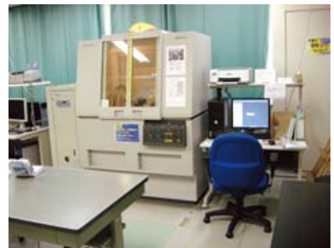
鹿児島大学機器分析施設の高速X線回折装置
